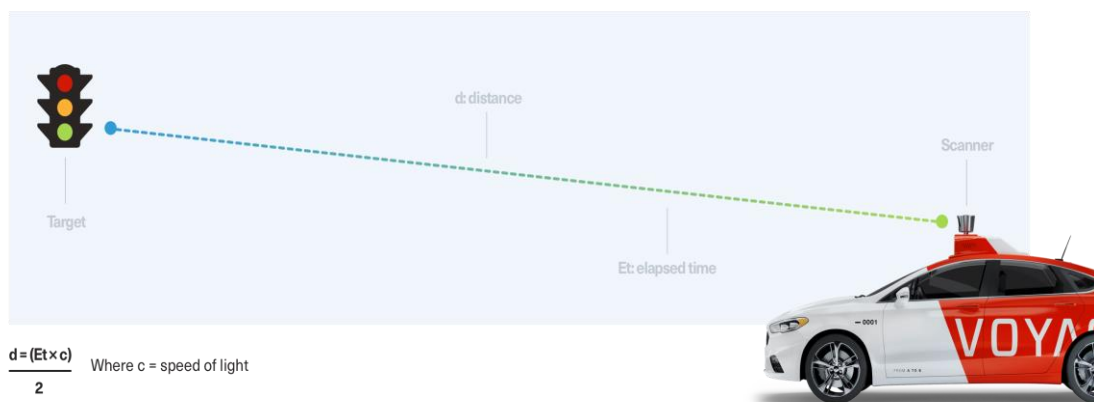
Gambar 1: Ilustrasi cara kerja sensor LiDAR pada AV [4]
